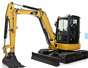
Kompakt- bagger 305.5 F Einsatzgewicht ca. 5,5 t
